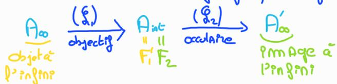
L'image intermédiaire de Mars doit se former dans le plan focal objet de l'oculaire.
