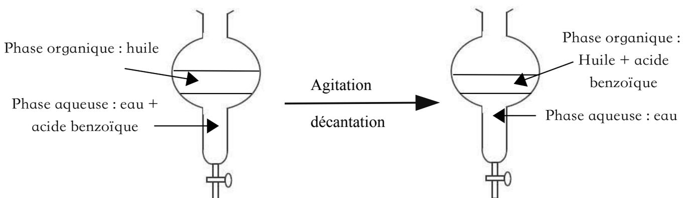
La phase aqueuse se situe en dessous car la densité de l'eau est supérieure à celle de l'huile.
