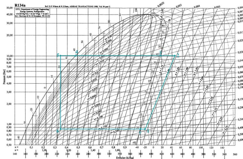
2.  $p_{vap} \simeq 0.85$  bar,  $p_{cond} \simeq 10$  bar,  $x_{v,6} \simeq 0.30$ ,  $T_2 \simeq 65^\circ\text{C}$  et  $T_6 \simeq -30^\circ\text{C}$ .
