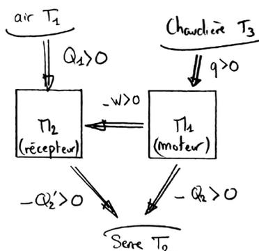
2. En supposant la chaudière comme parfaite et en régime permanent, la chaleur  $q$  reçue par cette dernière est transmise intégralement au moteur. Réalisons un bilan d'énergie sur un cycle du moteur  $\Delta U = W + q + Q_2 = 0$  et écrivons l'égalité de Clausius  $q/T_3 + Q_2/T_2 = 0$  ainsi on obtient l'expression du travail échangé entre les deux machines thermiques :
