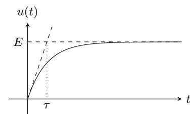
FIGURE 2 – Charge d'un condensateur
