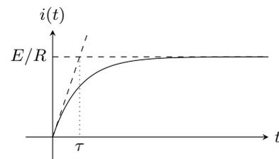
FIGURE 4 – Établissement du courant dans une bobine
