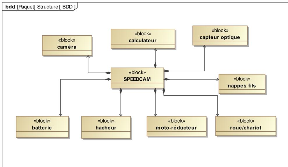
FIGURE 2 – Diagramme BDD du système *Speedcam*
