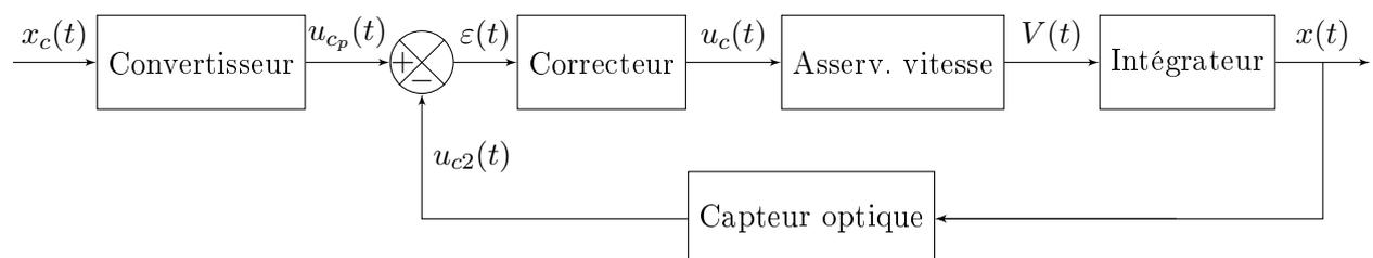
C'est le capteur optique qui réalise la mesure de la position linéaire réelle.
