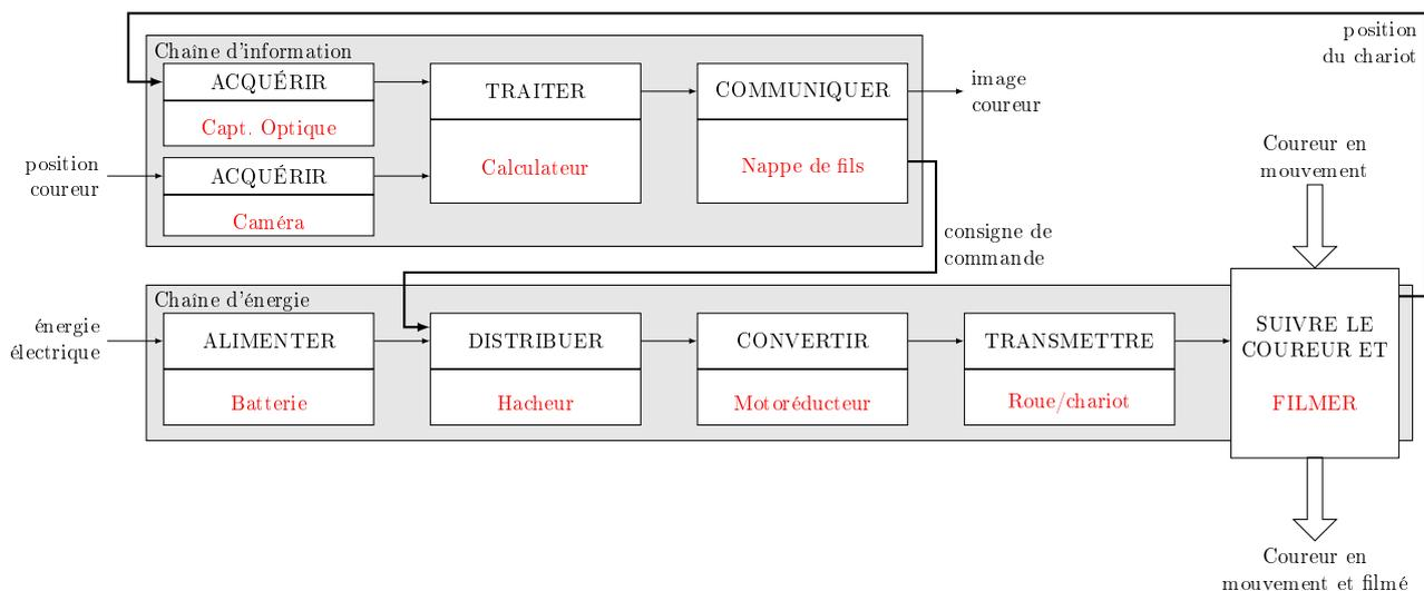
FIGURE 1 – Diagramme des chaînes fonctionnelles du système *Speedcam*
