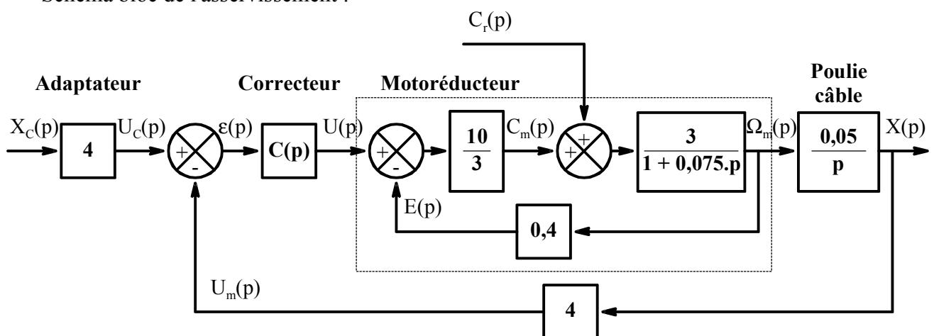
2.1- Du schéma bloc on calcule la fonction de transfert du moteur pour une perturbation nulle :
