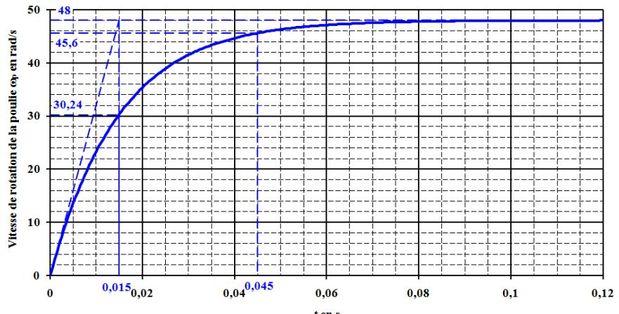
Le premier relevé permet de déterminer le gain statique :  $K_m = \frac{48}{24} = 2 \text{ rad.s}^{-1} \cdot V^{-1}$
