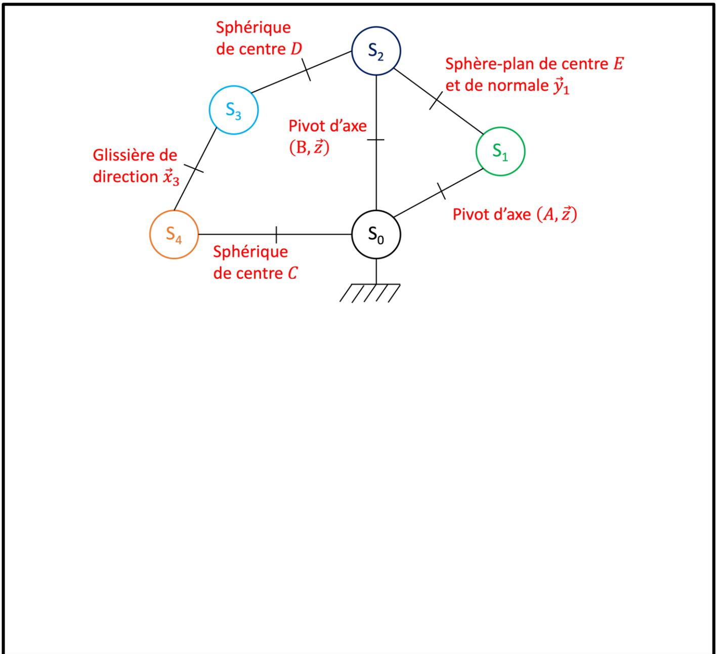
Q4. Tracer les figures du changement de base associées au paramétrage du mécanisme d'ouverture de la porte cargo.
