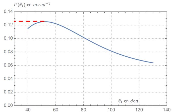
**Q9.** Si l'on souhaite que la vitesse angulaire de la porte  $\dot{\theta}_1$  soit au moins de  $3^\circ.s^{-1}$  pour toute configuration entre la position fermée et la position ouverte, quelle doit être la vitesse linéaire de l'actionneur en  $mm.s^{-1}$  ? On détaillera le raisonnement de manière littérale. Pour l'application numérique, on veillera à justifier les valeurs employées par des tracés sur les figures ci-dessus.
