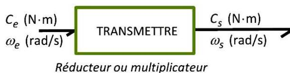
Réducteur et multiplicateur adaptent la puissance mécanique de rotation.
