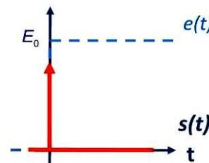
La réponse à un échelon d'amplitude  $E_0$  d'un système dérivateur est une impulsion d'amplitude  $KE_0$  :
