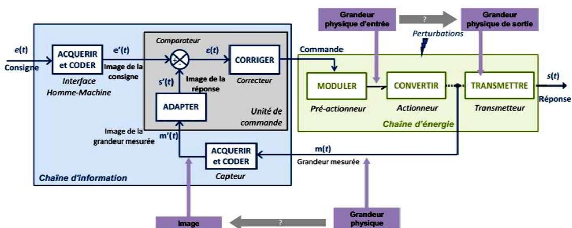
Modéliser en SLCI : modèle et Système Linéaire Continu Invariant Pour prédire les performances d'un système par simulation ou calcul, il faut pouvoir modéliser mathématiquement son comportement. Le modèle présenté ici est dit Linéaire, Continu, Invariant. Les Systèmes pouvant être modélisés ainsi sont les SLCI.
