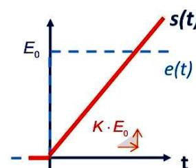
L'identification est réalisée à partir de la pente  $a$  en régime permanent avec  $a=KE_0$ .
