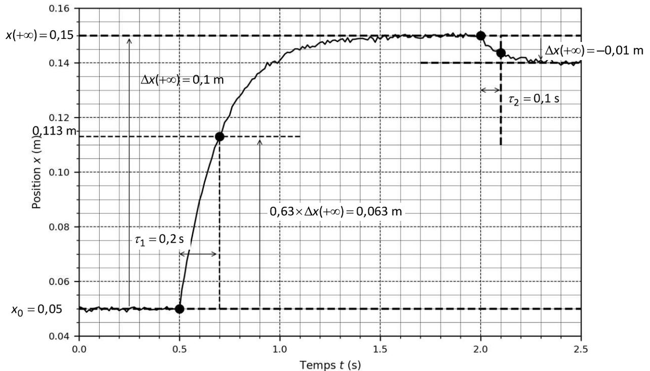
Pour validation du modèle, on peut tracer la tangente à l'origine et vérifier que  $t_{r,5\%}$  est proche de  $3\tau = 0,6$  s.
