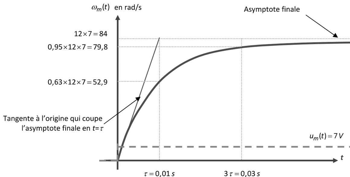
**Q3 :** Déterminer un modèle de comportement du hacheur  $\frac{U_m(p)}{C(p)}$ .
