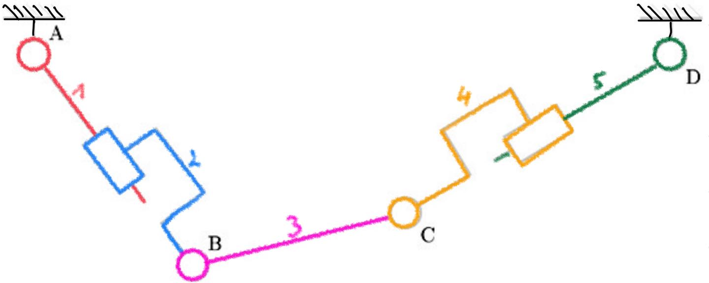
Q2: La liaison entre 1 et 0 est un pivot centré en A d'axe  $\vec{z}_0$  et de paramètre  $\theta_{10}$  (angle)
