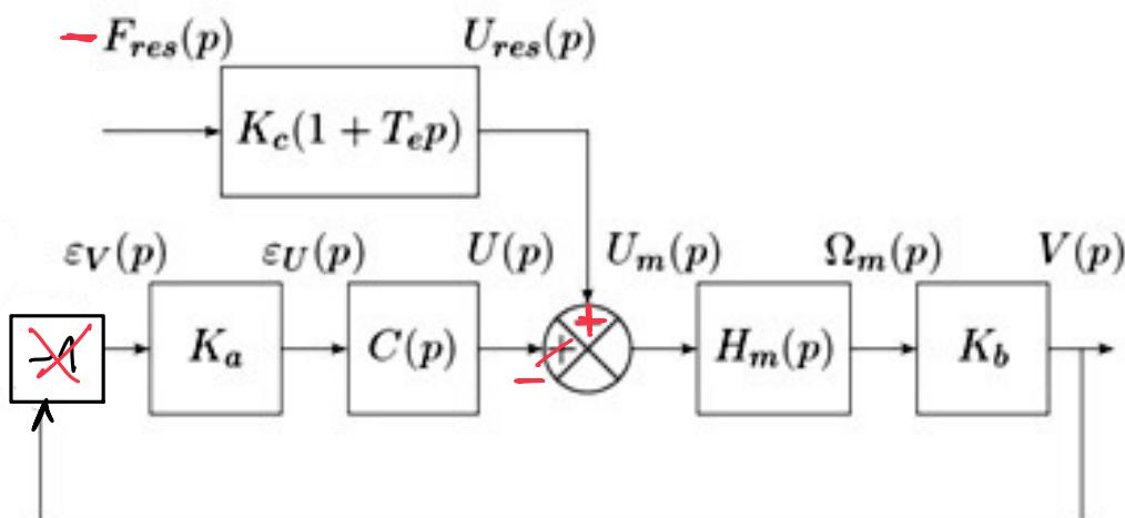
$$H_2(p) = k_c (1+T_e p) \times \frac{H_m K_b}{1 + k_a k_b C H_m} = k_c (1+T_e p) \frac{\frac{K_m K_b}{(1+T_e p)(1+T_m p)}}{1 + \frac{k_a k_b C K_m}{(1+T_e p)(1+T_m p)}}$$
