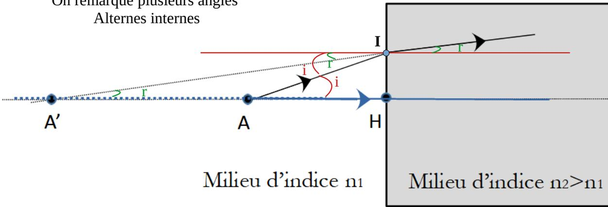
Rappels sur les conditions de Gauss : on suppose que les rayons sont peu inclinés par rapport à l'axe optique et proches de l'axe optique.
