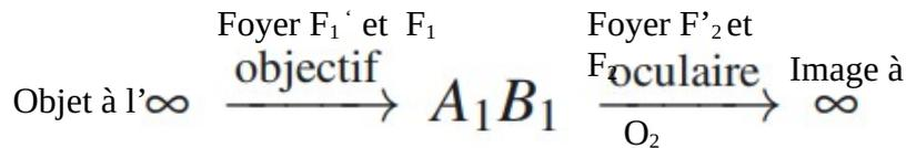
**À Retenir : Pour obtenir un système afocal, il faut donc disposer les lentilles de manière à ce que  $F_1' = F_2$**
