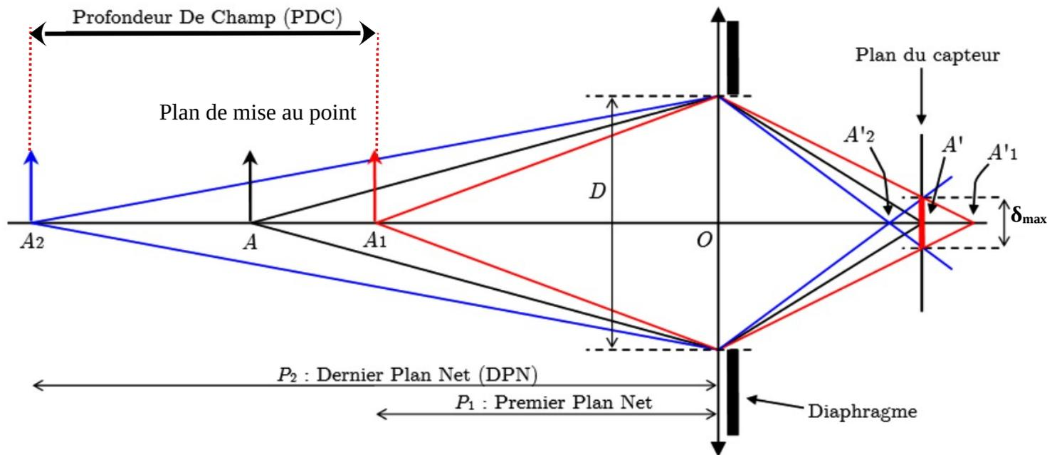
Pour une distance lentille-capteur fixée, on sait qu'il existe seulement un plan (plan de mise au point) dont on peut former une image nette sur le capteur.
