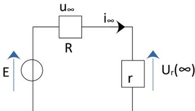
en appliquant le pont diviseur de tension :  $u_\infty = \frac{R}{r+R} E$
