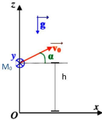
On étudie le mouvement d'une balle de masse  $m$ , assimilée à son centre de masse  $M$ , en chute libre, lancée avec une vitesse initiale  $v_0$  à une hauteur (ou côte)  $h$  de l'origine  $O$  du repère.
