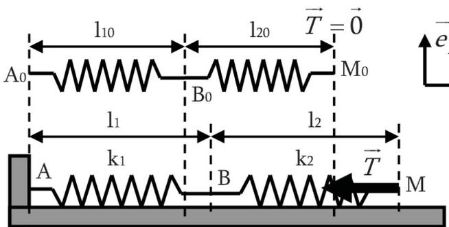
On associe en série (cf figure) deux ressorts élastiques sans masse, alignés, de raideurs  $k_1$  et  $k_2$ , de longueur à vide  $l_{01}$  et  $l_{02}$ , formant un système élastique unique de longueur totale  $l = l_1 + l_2$ .
