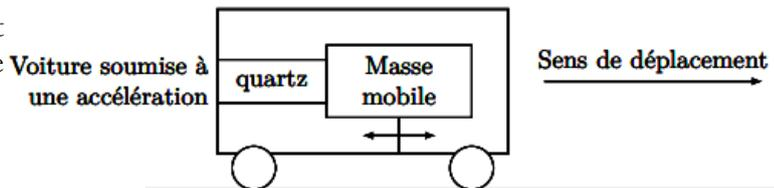
On néglige la déformation de la voiture de sorte que l'ensemble de celui-ci est animé de la même vitesse par rapport au sol à un instant donné. La voiture roule à la vitesse constante  $V = 90 \text{ km} \cdot \text{h}^{-1}$  soit  $25 \text{ m} \cdot \text{s}^{-1}$  et on suppose qu'elle s'arrête totalement en  $\Delta t = 0,15 \text{ s}$ .
