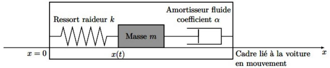
La masse  $m$  se déplace horizontalement et sans frottement solide sur un support lié à la voiture. Le ressort a pour constante de raideur  $k$  et pour longueur à vide  $L_0$ . L'amortisseur exerce une force de frottement fluide sur la masse, son expression étant  $\vec{f} = -\alpha \vec{V}$
