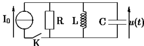
1 Établir l'équation différentielle vérifiée par la tension aux bornes du condensateur  $u(t)$ .
