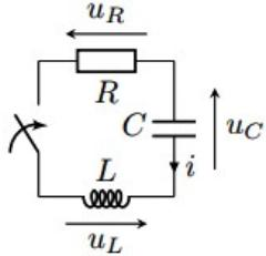
Les notations des courants et tensions ne sont pas explicitées sur le schéma par l'énoncé, auquel cas il est sous-entendu que toutes les tensions sont orientées de façon cohérente avec  $u_C$  et que les dipôles sont orientés en convention récepteur.
