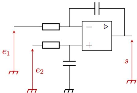
Exprimer dans le domaine fréquentiel (sous la forme d'une fonction de transfert) puis temporel (sous la forme d'une équation différentielle) la relation entre la tension de sortie et les deux tensions d'entrée du montage. Les deux résistances R et les deux condensateurs C sont identiques.
