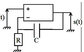
1. Déterminer la fonction de transfert de ce filtre. Que vaut le gain du filtre à très basse fréquence ? Que peut-on dire sur la valeur de  $s(t)$  ?
