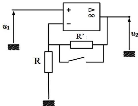
le montage est équivalent à un amplificateur non inverseur de gain :
