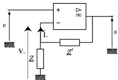
Il y a une rétroaction sur la borne -, le régime de fonctionnement est probablement linéaire. Si c'est bien le cas on a  $v_+ = v_-$ .
