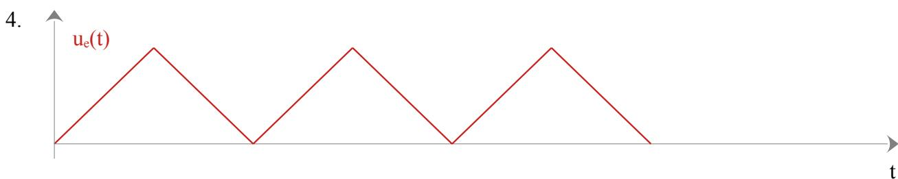
Sur la phase montante on a  $u_e(t) = at + b$  ( avec a positif pour que la tension augmente)
