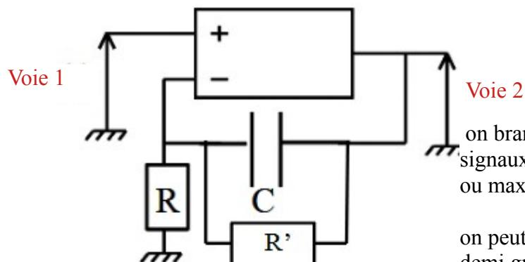
on branche les voies 1 et 2 comme indiqué on affiche les deux signaux en même temps et on vérifie si un signal est extrémal (min ou max) quand l'autre est nul
