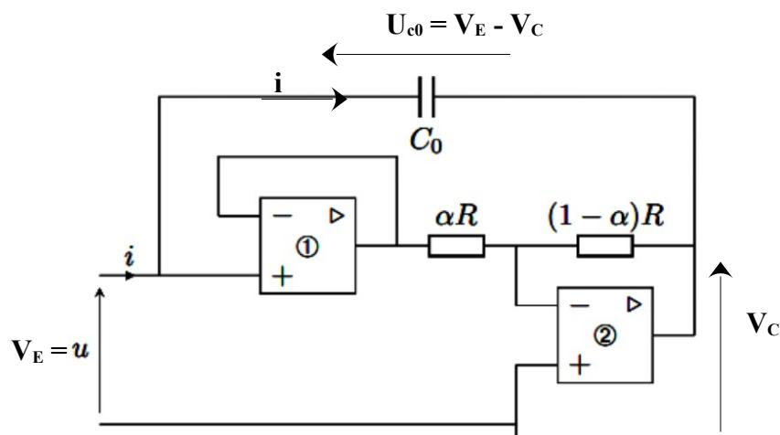
On veut montrer que le montage équivaut à un condensateur. Concrètement, on cherche donc à établir une relation entre  $i$  et  $u$  qui soit celle d'un condensateur, soit  $u = \frac{1}{jC\omega} i$  ou dans le domaine réel  $i = C \frac{du}{dt}$  avec  $u = V_E$
