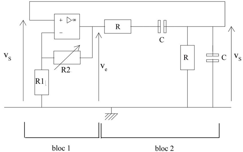
Pour le bloc 1, ayant pour entrée  $v_s$  et pour sortie  $v_e$ , on donne :  $v_e(t) = \frac{R_1 + R_2}{R_1} v_s(t)$ . On a donc
