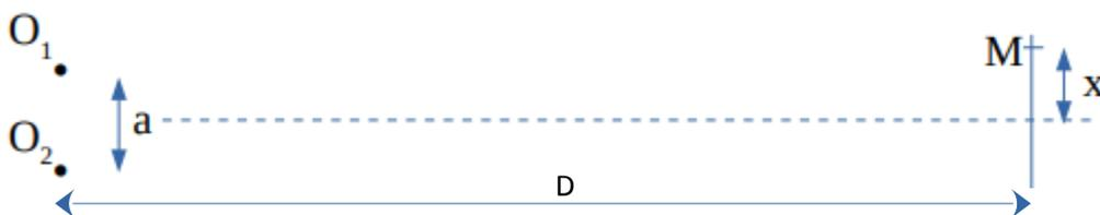
En  $O_1$  et  $O_2$  sont émis deux signaux sinusoïdaux  $s_1(t)$  et  $s_2(t)$  de même amplitude, en phase et de même longueur d'onde  $\lambda = 600$  nm.
