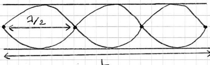
c. Lorsqu'une extrémité est fermée on a un nœud :
