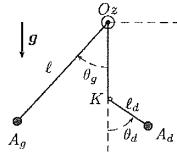
On considère un pendule asymétrique : un clou est fixé en K situé à 30 cm en dessous du point O (cf figure ci-dessous). Ainsi, à gauche de la verticale, le pendule se balance selon une rotation du tronçon OAg du fil autour de O; à droite, c'est le tronçon KA<sub>d</sub>, de longueur  $\ell_d$ , qui tourne autour de K. On note  $\theta$  l'angle que forme le pendule avec la verticale à gauche et  $\theta_d$  l'angle des oscillations à droite de OK.
