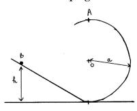
Une gouttière a l'allure ci-contre. On lâche un point matériel M de masse m du point B avec une vitesse initiale nulle. Le mouvement se fait sans frottements et dans le plan vertical.
