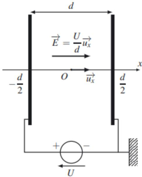
On applique une différence de potentielle entre les deux électrodes
