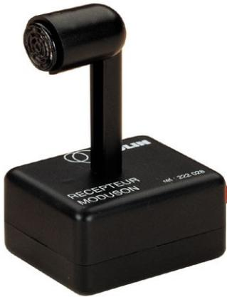
L'objectif est de mesurer la vitesse de propagation des ultrasons. Les émetteurs-récepteurs fonctionnent en ultrasons, autour de 40 kHz.
