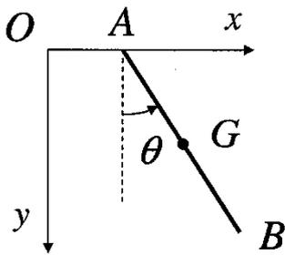
On considère une barre homogène AB de masse m et de longueur 2l. Son moment d'inertie par rapport à l'axe  $\Delta = (A, \vec{e}_z)$  vaut  $J_\Delta = \frac{1}{3}m(2l)^2$ . Le point A est fixe. la barre est lâchée avec une angle  $\theta_0$  et avec une vitesse initiale nulle.
