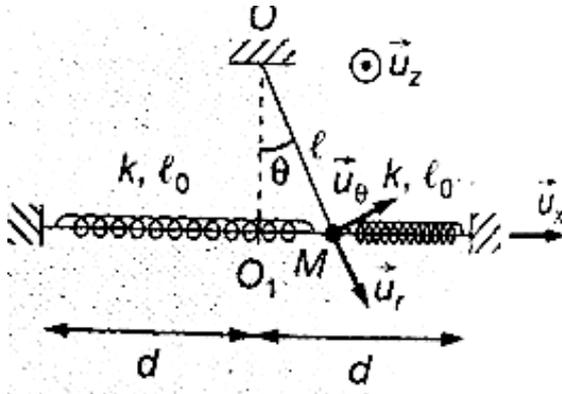
Une bille M de masse m est reliée à un fil inextensible (longueur l, masse négligeable devant m) et à deux ressorts horizontaux (raideur k, longueur à vide  $l_0$ ). A l'équilibre, la bille est en  $O_1$  et la longueur de chaque ressort vaut  $l_0$ . On se place dans la limite des petits angles : on supposera l'angle  $\theta$  entre la verticale et le fil suffisamment petit pour que les ressorts restent horizontaux. On notera x la distance  $O_1M$ , supposée bien inférieure à d.
