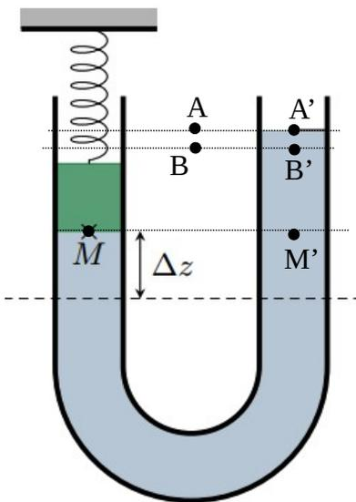
On dispose dans un tube en U un bouchon accroché à un ressort qui exerce une force répulsive sur le bouchon, ce qui impose une pression  $P$  en  $M$
