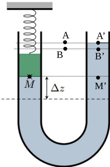
On dispose dans un tube en U un bouchon accroché à un ressort qui exerce une force répulsive sur le bouchon, ce qui impose une pression  $P$  en  $M$
