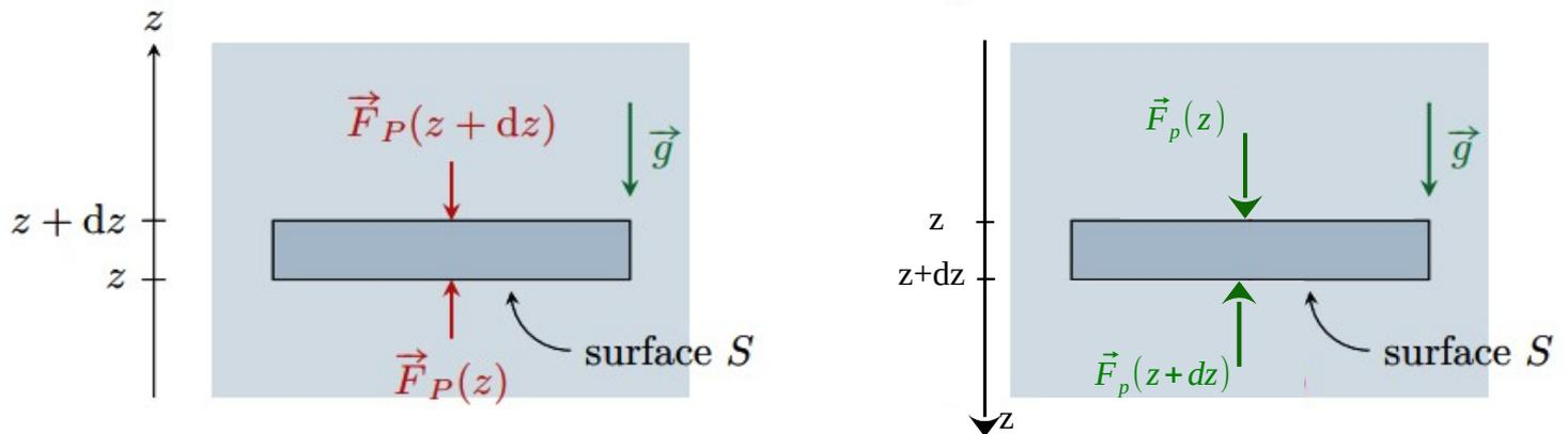
La particule de fluide est méso dans la direction z mais macro dans les directions x et y. On raisonne donc sur une tranche mésoscopique de fluide à l'équilibre, de surface S et hauteur infinitésimale dz
