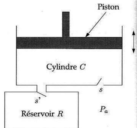
1. a) En supposant que le piston se déplace assez lentement pour que l'air reste à température constante, calculer le volume  $V'_1$  pour lequel  $S'$  s'ouvre en fonction de  $P_0$ ,  $P_a$  et  $V_M$ .
