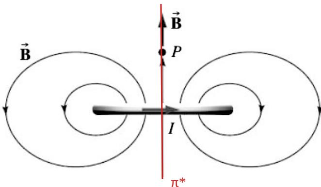
P est dans le plan d'antisymétrie de la distribution de courant, le champ magnétique en P est donc contenu dans ce plan, on trouve la direction avec la règle de la main droite
