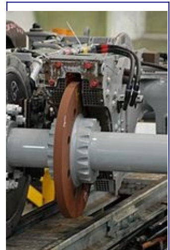
Illustration 2: Frein à courants de Foucault sur un train rapide japonais Shinkansen.
