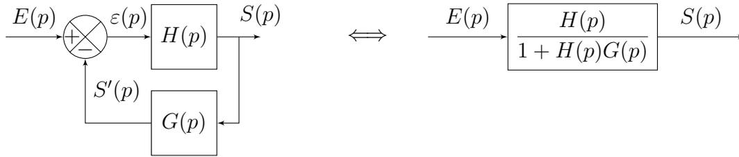
Il est utile dans l'analyse des systèmes d'introduire la notion de fonction de transfert en boucle ouverte (FTBO). Elle est définie comme :
