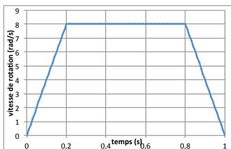
FIGURE 2.1 – Loi en trapèze de vitesse.
