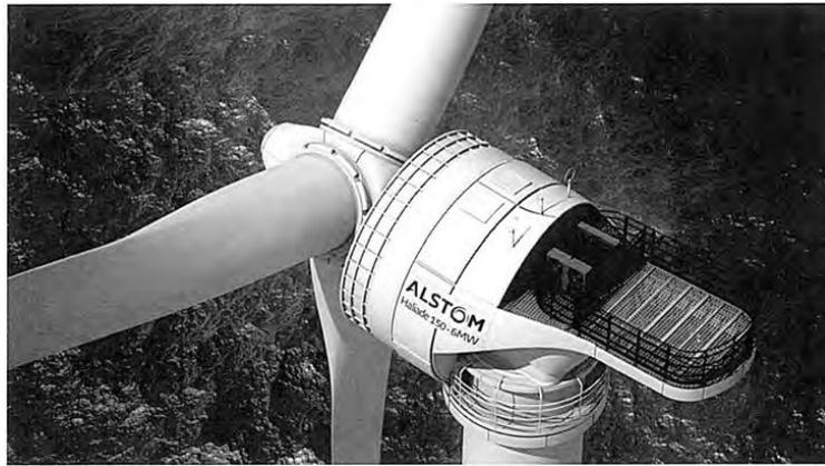
On désire asservir la position angulaire  $\theta$  de la nacelle à la position angulaire  $\theta_c$ , de la girouette. La position angulaire  $\theta_c$  de la girouette est convertie en une tension  $V_c$ , proportionnelle à  $\theta_c$ , par un potentiomètre linéaire circulaire de gain  $K_c$ .
