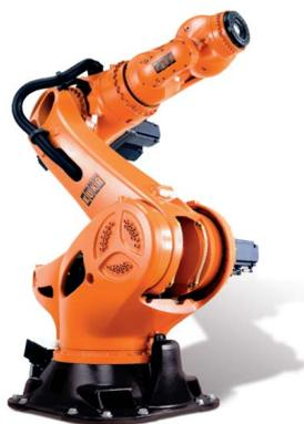
Dans une chaîne automobile, les robots servent, entre autres, à déplacer des tôles embouties afin de faciliter le montage final. Pour des questions de rentabilité, on cherche à minimiser le temps de cycle donc le temps de déplacement du bras robotisé. Pour cela, on envisage deux types de loi de commande :
