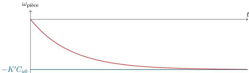
**Question 1.14.** On constate ici la présence d'une erreur due à la perturbation. Pour annuler cette erreur, il est nécessaire de mettre en place un asservissement. Il est possible d'utiliser une génératrice tachymétrique pour acquérir une image de la vitesse.
