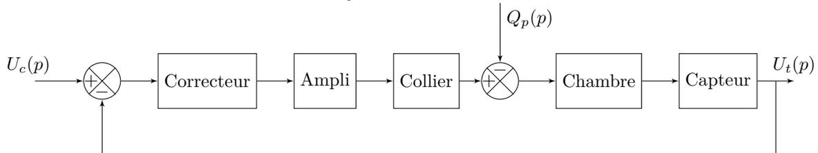
**Question 7.5.** Dans le cas particulier d'un retour unitaire, la chaîne directe et la FTBO sont confondues. Il vient alors par formule de Black et simplification du type «  $\frac{N/D}{1+N/D} = \frac{N}{N+D}$  » :
