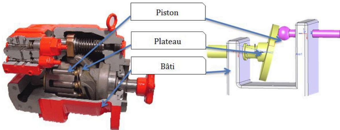
**Question 1.4.** Identifier les classes d'équivalences puis réaliser le graphe de structure de la pompe à pistons axiaux.
