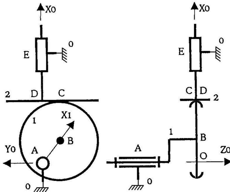
FIGURE 5.1 – Schéma cinématique de la pompe à pistons radiaux.
