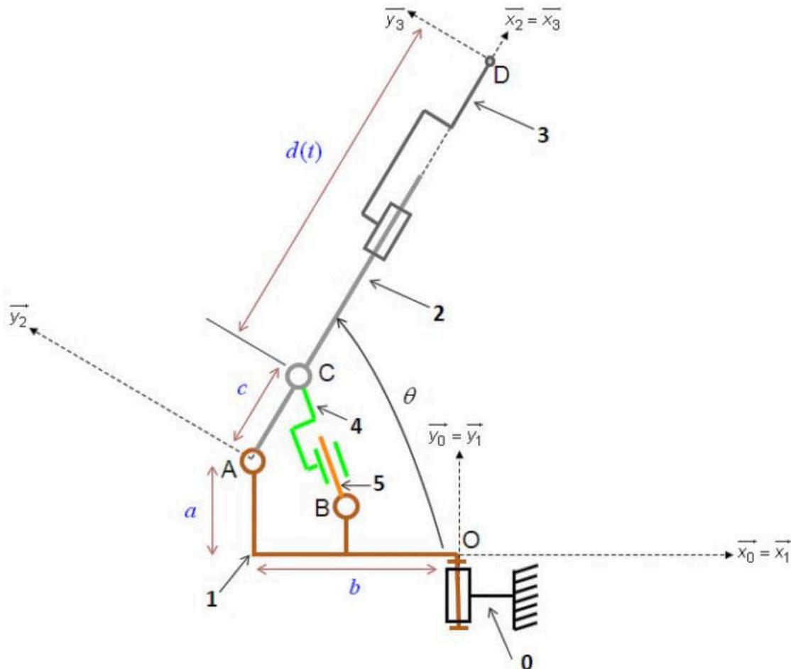
FIGURE 4.1 – Schéma cinématique de l'échelle E.P.A.S.
