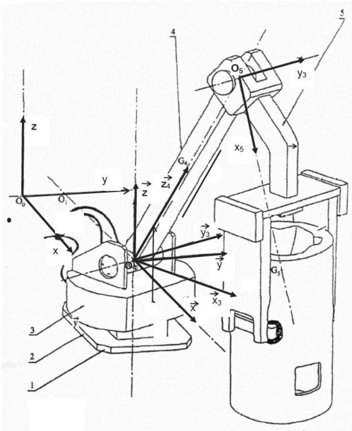
FIGURE 2.1 – Paramétrage de l'extracteur de pièces de fonderie.
