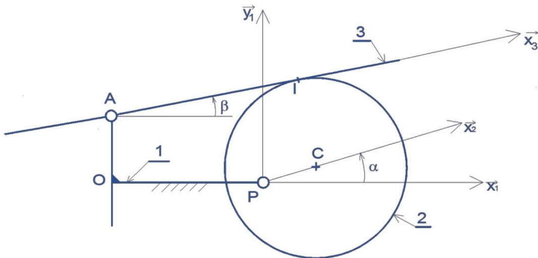
FIGURE 6.2 – Schéma cinématique simplifié du VTEC.
