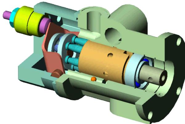
FIGURE 7.3 – Écorché CAO de la pompe hydraulique.
