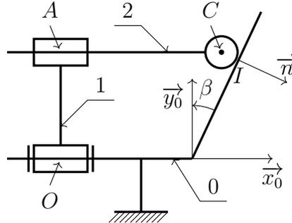
FIGURE 7.4 – Schéma cinématique minimal de la pompe.
