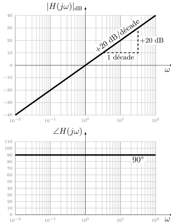
FIGURE 9 – Diagrammes de Bode d'un dérivateur.
