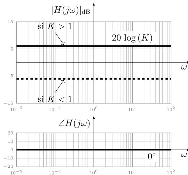
FIGURE 7 – Diagrammes de Bode d'un gain pur.
