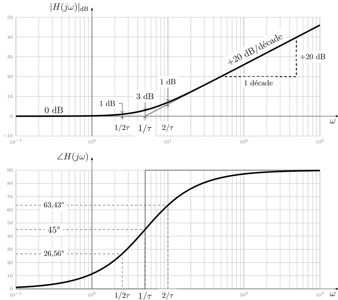
FIGURE 11 – Diagrammes de Bode d'un numérateur d'ordre 1 avec  $\tau = 0,2 \text{ s}$ .
