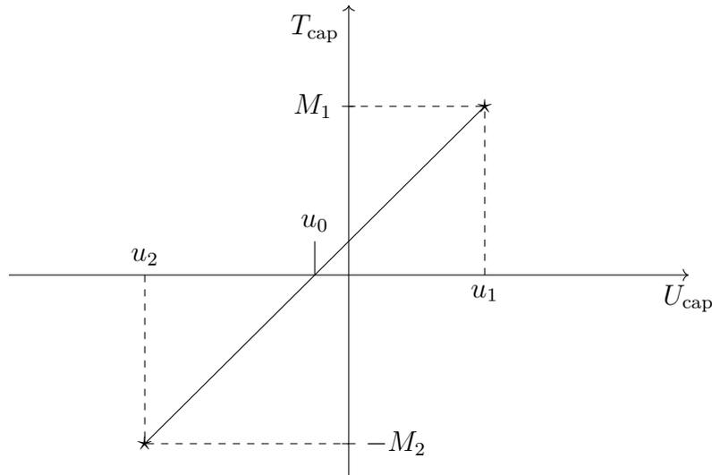
où  $u_0$  n'est pas forcément nulle ; d'où la nécessité d'une mesure avec le capteur en traction et une mesure du capteur en compression.
