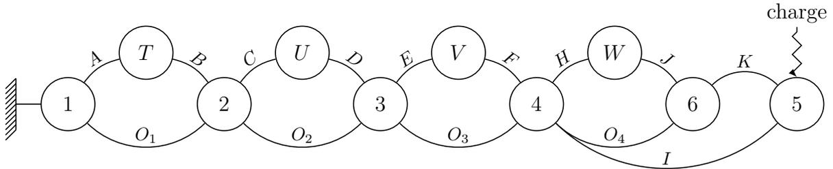
Notant que les vérins  $T$ ,  $U$ ,  $V$  et  $W$  sont chacun soumis à 2 glisseurs, il vient par théorème d'un solide soumis à deux glisseurs que les axes centraux des torseurs d'actions mécaniques transmissibles par les vérins sont :
