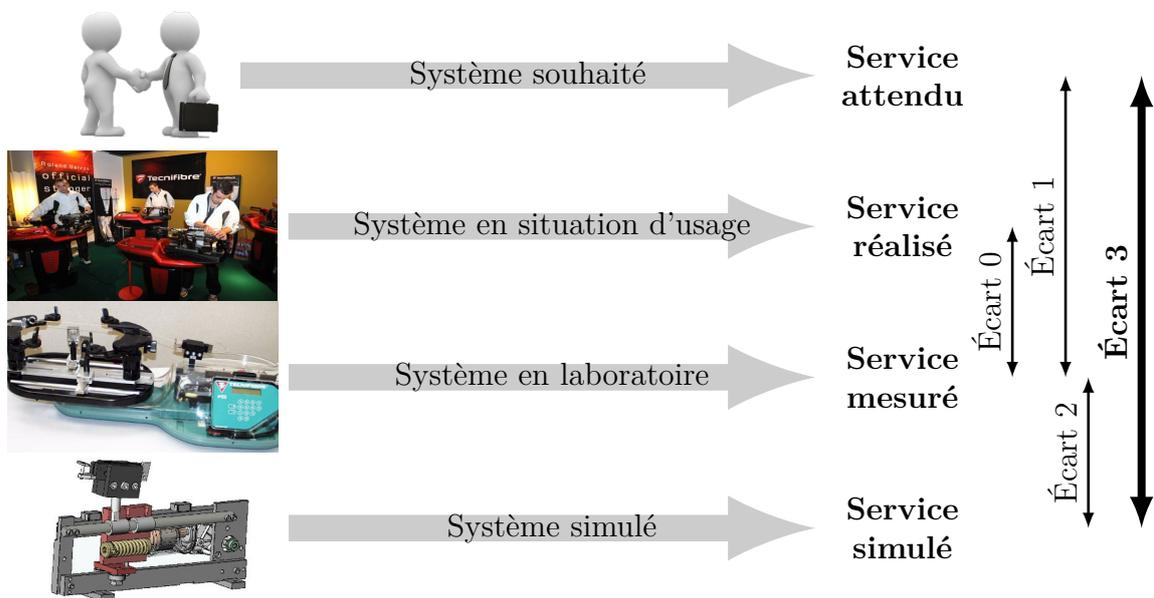
**Écart 0** – évalue la fiabilité et la fidélité du système de laboratoire didactisé par rapport au système réel. Il répond aux questions « le système de laboratoire est-il représentatif du système réel ? Permet-il de l'étudier de manière fiable ? »
