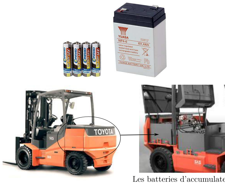
FIGURE 10 – Chariot élévateur TOYOTA Traigo et son alimentation continue de 48 V.
