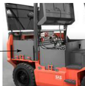
Les batteries d'accumulateur
