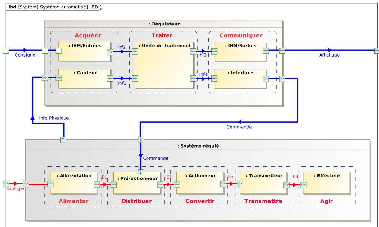
FIGURE 14 – Architecture fonctionnelle d'un système automatisé.
