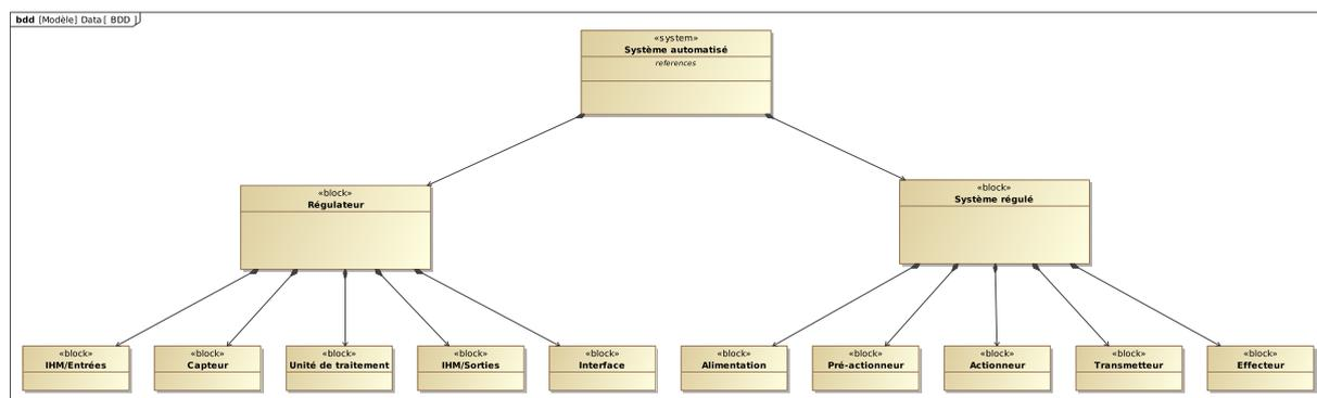
FIGURE 13 – Architecture logique d'un système automatisé.
