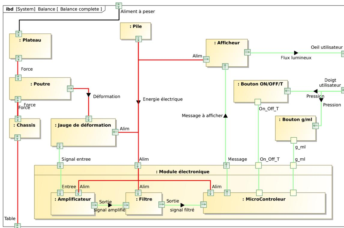
Sur ce diagramme, on peut voir exactement les mêmes blocs que sur le diagramme de définition des blocs à la différence que cette fois ils sont placés dans leur bloc conteneur (cas de l'amplificateur, du filtre et du micro-contrôleur du module électronique). On distingue très clairement le flux d'énergie électrique qui va de la pile aux différents
