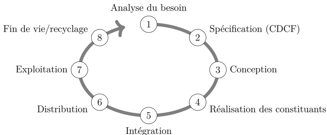
FIGURE 4 – Cycle de vie d'un produit.
