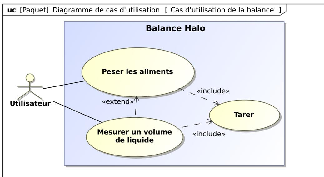
La fonction *peser des aliments* peut être étendue à la mesure du volume d'un liquide moyennant une conversion. Cette extension (non nécessaire à la pesée) est signifiée par un lien ←---- sur lequel figure la mention « **extend** ». De même, la mesure d'une masse d'aliments implique d'avoir au préalable taré la balance. La fonction *tarer* est donc incluse dans la fonction de pesée; ce qui est signifié par un lien d'inclusion ----> sur lequel figure la mention « **include** ».
