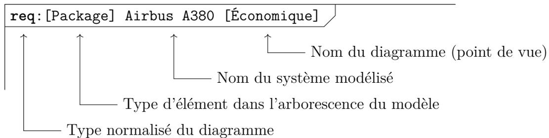
FIGURE 11 – Exemple de cartouche d'un diagramme SysML.
