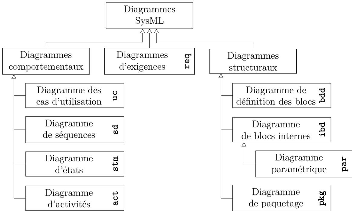
FIGURE 10 – Diagrammes SysML.
