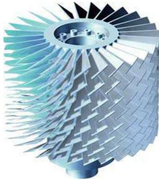
FIGURE 4.2 – Rotor de la pompe.
