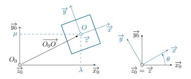
2 paramètres linéaires et 1 paramètre angulaire tels que  $\forall \mathcal{S}$  en mouvement dans  $\mathcal{R}_0$  :
