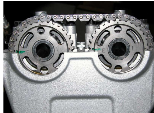
Chaîne reliant deux arbres à cames
