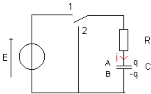
Interrupteur en position 1 : charge
