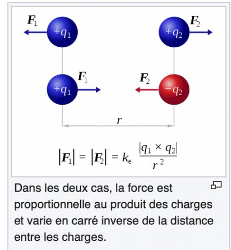
On en déduit l'expression du champ électrostatique créé par la charge ponctuelle  $q_1$  :  $\vec{F}_{1 \rightarrow 2} = q_2 \cdot \vec{E}_1$  soit  $\vec{E}_1 = +k \frac{q_1}{r^2} \vec{u}$
