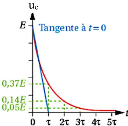
✓ Dans le cadre d'une décharge, le temps caractéristique  $\tau = RC$  correspond à la durée nécessaire pour que le condensateur ne soit plus chargé qu'à 37% de sa charge initiale. Au bout d'une durée de  $5\tau$ , le régime transitoire de décharge est terminé :  $u_c(t > 5\tau) = 0$ .
