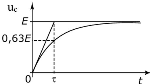
✓ Dans le cadre d'une charge, le temps caractéristique  $\tau = RC$  est la durée nécessaire pour que le condensateur soit chargé à 63% de sa charge finale maximale. Au bout d'une durée de  $5\tau$ , on considère que le régime transitoire de charge est terminé et la tension au bornes du condensateur correspond à la tension du générateur idéal :  $u_c(t > 5\tau) = E$ .
