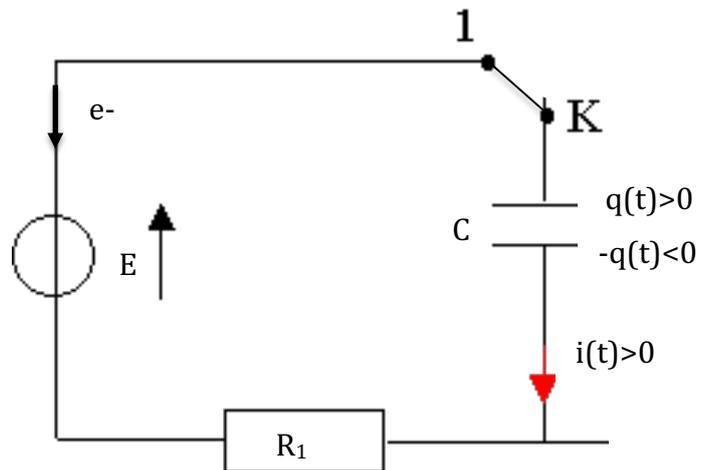
4. Loi d'ohm :  $u_R = R_1 i$  et relation tension-intensité :  $i = C \frac{du_c}{dt}$
