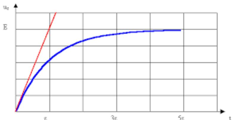
7. Loi d'ohm :  $u_R = R_2 i$  et relation tension-intensité :  $i = C \frac{du_c}{dt}$
