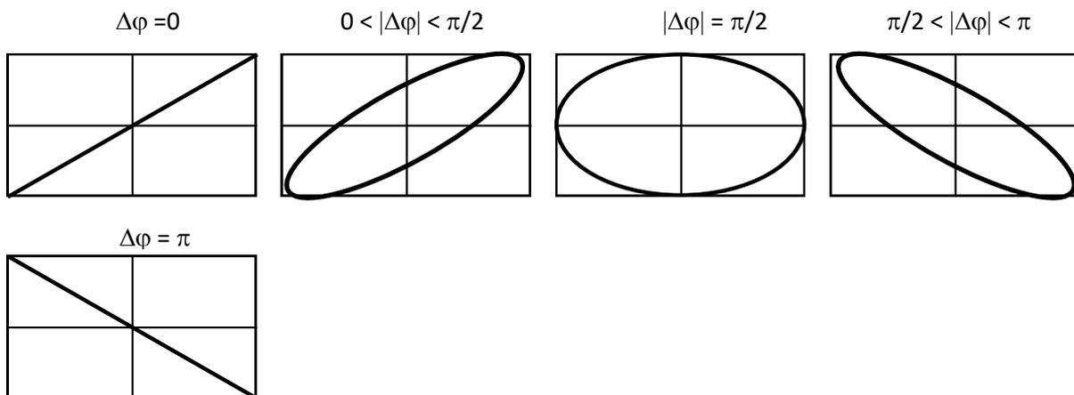
HORS PROGRAMME : la méthode de Lissajous permet de calculer quantitativement le déphasage  $\Delta\varphi$  entre les deux signaux à partir de l'ellipse, on suppose que  $u_1$  possède une phase à l'origine nulle soit  $u_1(t) = a \cdot \cos(\omega t)$  et que  $u_2(t) = b \cdot \cos(\omega t + \varphi)$  : ainsi  $|\varphi| = |\Delta\varphi|$ .
