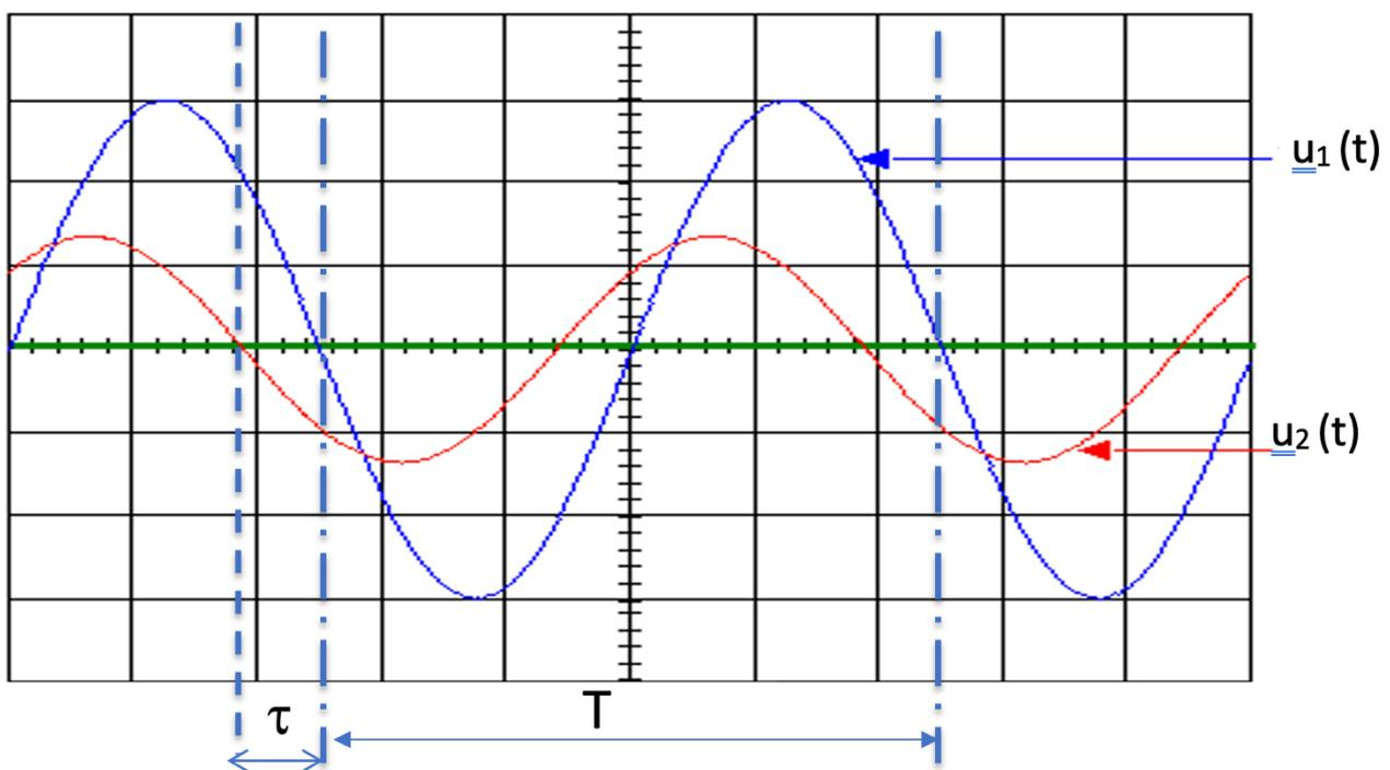
On mesure les durées  $\tau$  et  $T$  à l'aide des curseurs (**touche [cursors] du menu *Measure***) pour calculer la valeur absolue du déphasage exprimée en radians :  $|\Delta\varphi| = 2\pi \cdot \frac{\tau}{T}$ . Il est plus précis de faire la mesure au niveau de l'axe des abscisses plutôt qu'au sommet des courbes. Il est intéressant d'utiliser des bases de temps différentes pour la mesure de  $\tau$  et de  $T$  afin d'être le plus précis possible dans le positionnement des curseurs.
