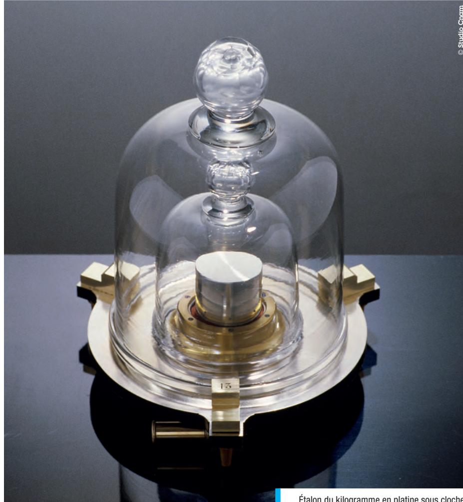
Étalon du kilogramme en platine sous cloche.
