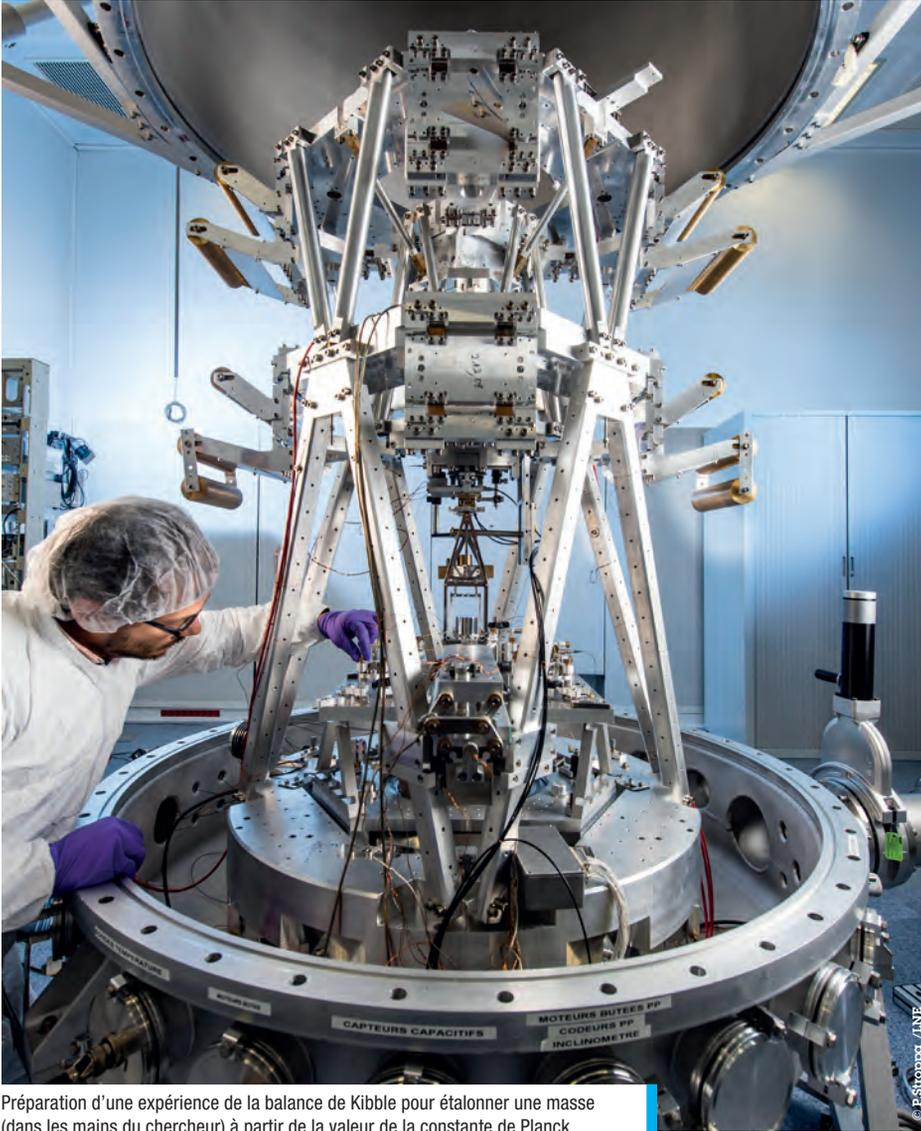
Préparation d'une expérience de la balance de Kibble pour étalonner une masse (dans les mains du chercheur) à partir de la valeur de la constante de Planck.
