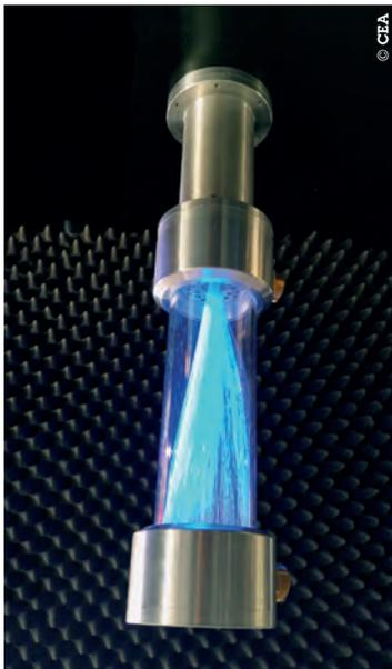
Le dispositif SafeWater permet de repérer des traces de contamination radioactive dans l'eau.
