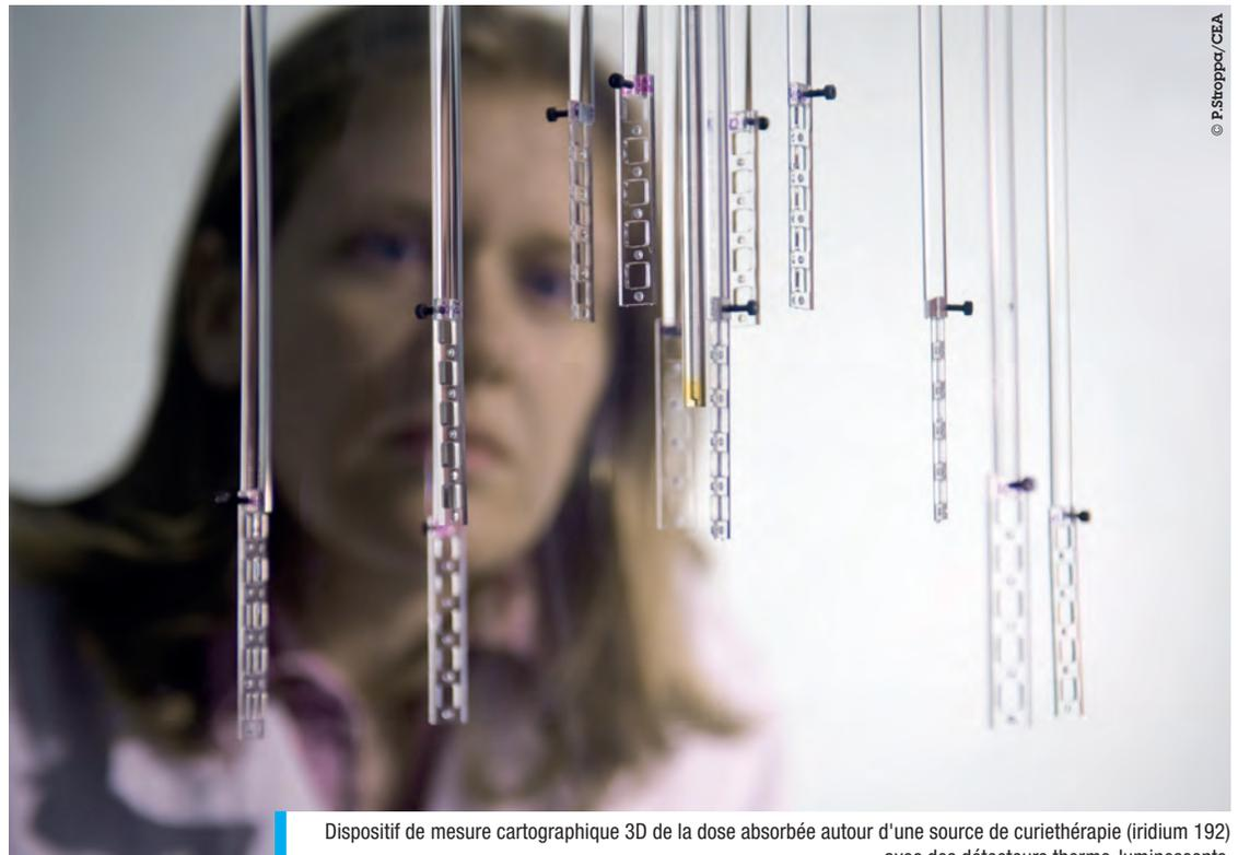
Dispositif de mesure cartographique 3D de la dose absorbée autour d'une source de curiethérapie (iridium 192) avec des détecteurs thermo-luminescents.
